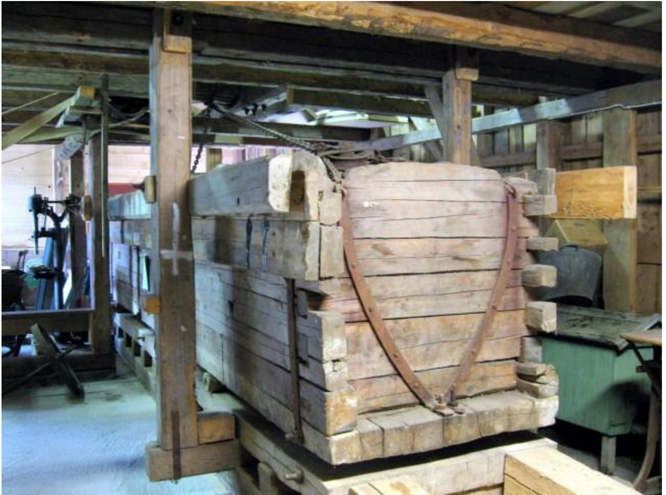
Stenmangeln i hembygdsmuseet, mangelkistan fylld med sten väger ca 20 ton. Foto från 2006.
